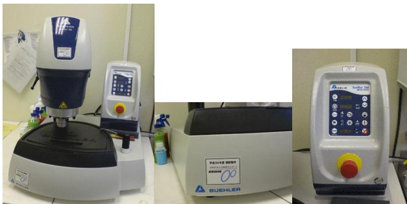
写真 自動研磨装置
